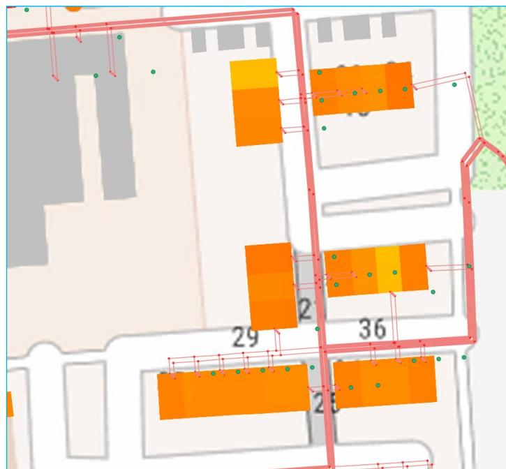
Abbildung 30: Darstellung nach gruppiertem jährlichem Warmwasserbedarf
